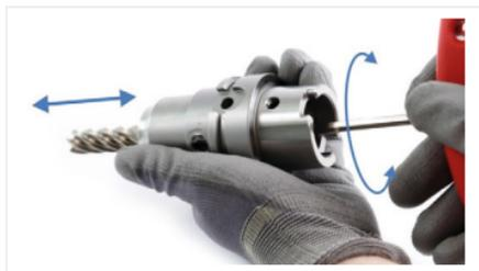
Abb. 8: Werkzeuglänge einstellen (axial)
