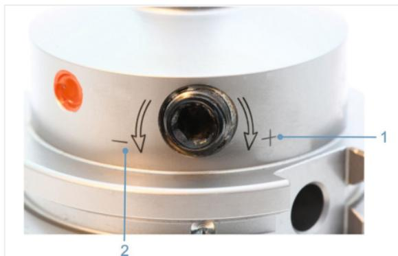
Abb. 5: Drehrichtungsangabe zum Lösen und Spannen des Werkzeugs
