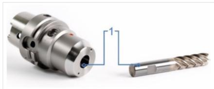
Abb. 6: HTC Spannfutter und Werkzeug reinigen
