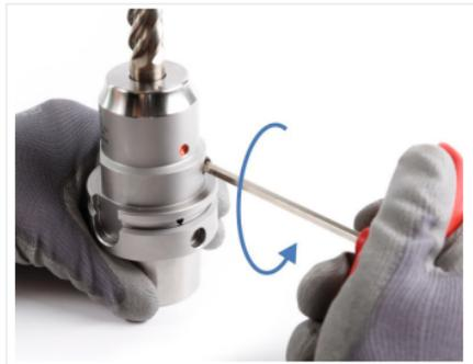
Abb. 12: Spansschraube lösen
