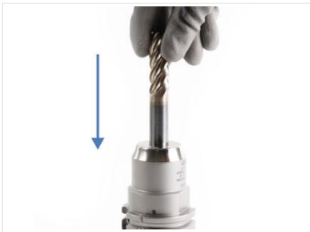
Abb. 7: Werkzeug einschieben
